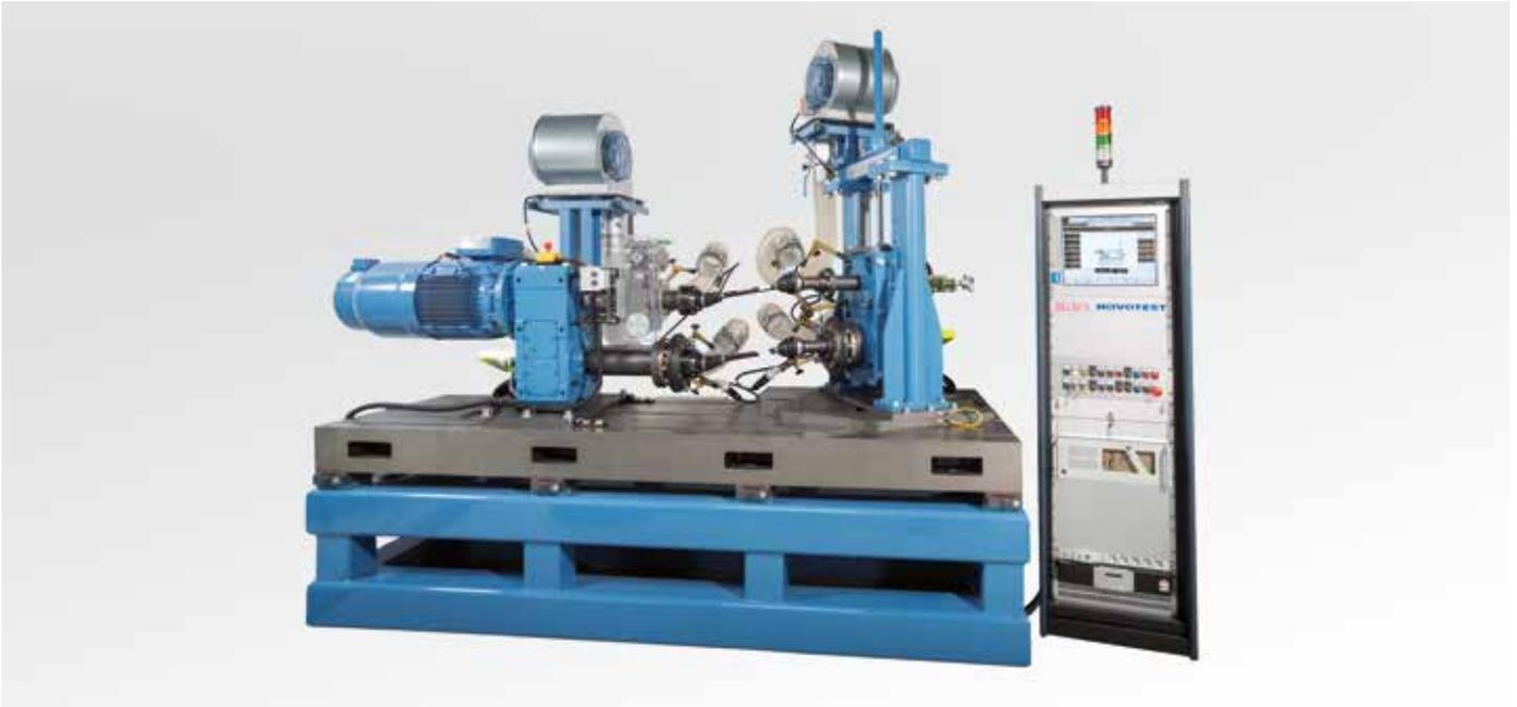
该实验台用于确定等速传动轴的抗破坏性能。
