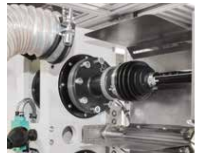
油脂泄漏监控及吹风模拟装置
