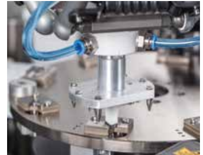
Teilehandlung über 4-Achs High-Speed-Roboter mit Vakuumgreifer
