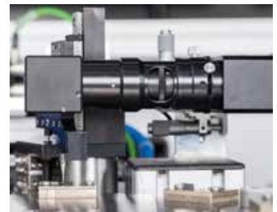
Erweiterbar mit präziser Messung durch Bildverarbeitungssystem
