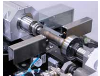
Schnelle und hochflexible Erfassung der Bauteilgeometrie von Wellen
