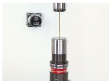
Измерение длины инструмента
