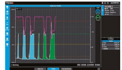
Controllo adattivo: Visualizzazione della regolazione dell'avanzamento e del taglio effettivo
