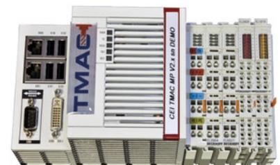
El PC de TMAC procesa los datos del transductor de potencia, así como los comandos del CNC y comunica al PC de visualización.
