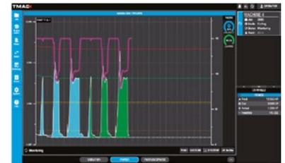
Control adaptativo: visualización del ajuste de la velocidad de corte y el corte real
