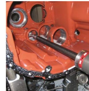
在涡轮机零件内部进行测量
