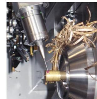
刀具测量TC76 搭配护套
