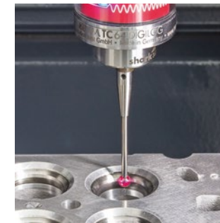
Analogové skenování obrysů těsnicí fazety na sedle ventilu
