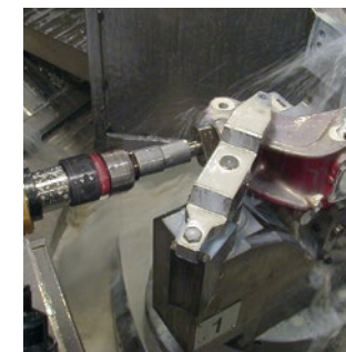
Měření otvoru v čepu nápravy před drážkováním
