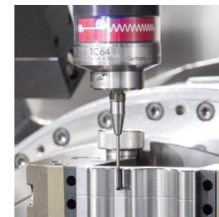
TC64-RG – měření drsnosti v obráběcím centru
