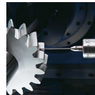
Detekce chyb obrábění na brusce ozubení
