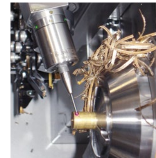
Měření obrobku v soustruhu
