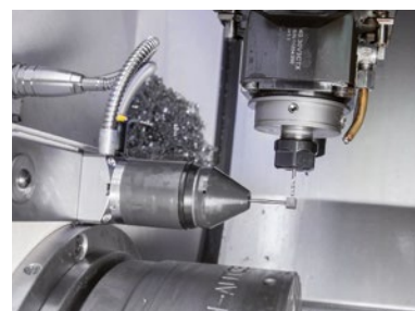
Pomiar narzędzia – TC76 z osłoną przesuwaną
