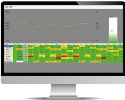
Aktuelle und vorhergehende Messdaten & Werkzeugstandzeit
